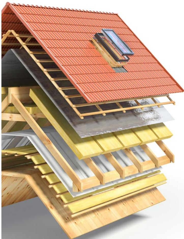
I nostri tetti in legno hanno sempre come base il legno lamellare, che garantisce stabilità, efficienza strutturale e design, oltre a una specifica coibentazione termica che garantisce isolamento sia termico che acustico. Un buon isolamento è necessario per scongiurare fenomeni di condensa dovuta agli sbalzi termici tra ambiente esterno e ambiente interno.
